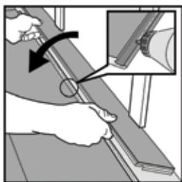
Com a ajuda de um formão, corte o elemento de encaixe, aplique cola para PVC na faixa cortada e pressione as peças em conjunto, no sentido horizontal. Se necessário, coloque espaçadores entre a peça final e a parede, enquanto a cola endurece.
