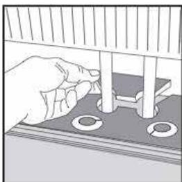
Faça aberturas **10 mm maiores** que o diâmetro dos tubos. Cole o bloco em conjunto, atrás dos tubos. Esta regra aplica-se a todos os elementos fixos existentes.
